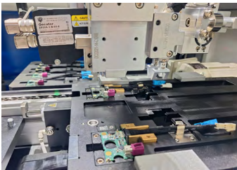
Fig. 2: Sistema de visión para revisión de piezas en 3D
