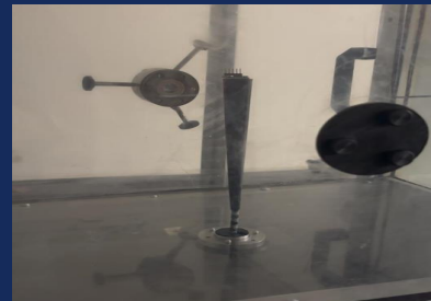
Figura 2. Prueba del prototipo montado en el túnel de viento para confirmar su frecuencia natural mediante excitación aerodinámica y análisis de respuesta vibratoria.
