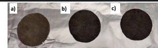
Fig. 6 a) Membrana con 0.12 gramos de CuS b) membrana con 0.25 gramos de CuS y c) con 0.5 gramos de CuS
