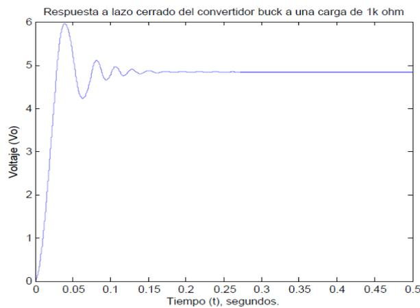
Figura 13. Respuesta a lazo cerrado del convertidor buck
