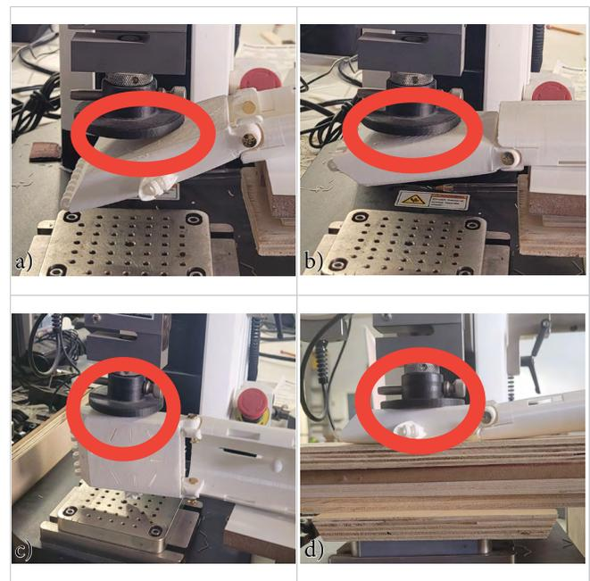
Figura 7. Punto de contacto entre la mano y la cruceta de la máquina: a) supinación, b) pronación, c) neutral y d) fuerzas de compresión en supinación.
