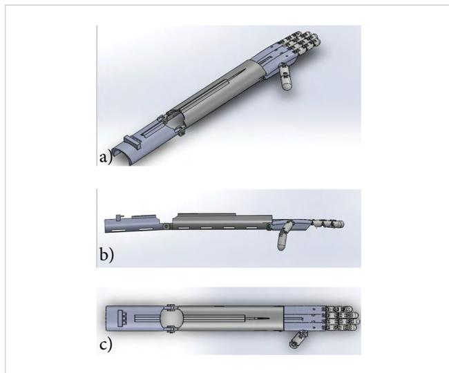
Figura 9. Diseño de prótesis con parámetros modificados: a) vista isométrica, b) vista frontal y c) vista superior.
