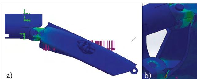
Figura 20. Deformación resultante en PLA en SolidWorks: a) simulación de la aplicación de las fuerzas en posición de pronación y b) acercamiento a la zona afectada en la parte inferior de la zona de ensamble mano-antebrazo.
