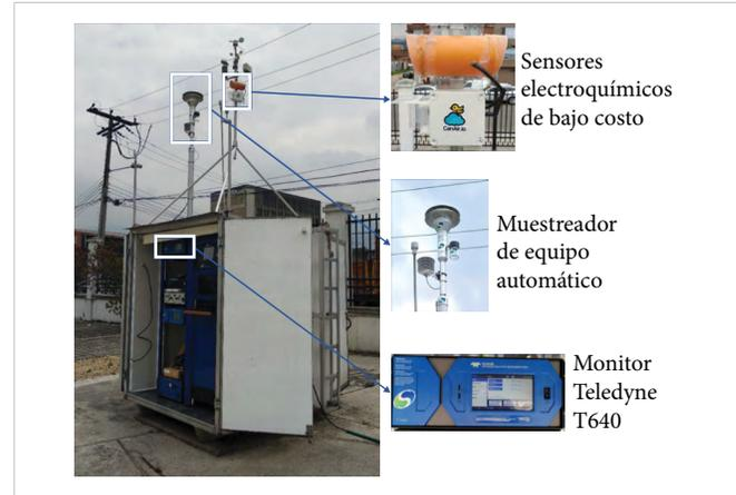
Figura 1. Disposición del equipo certificado y sensores de bajo costo.
