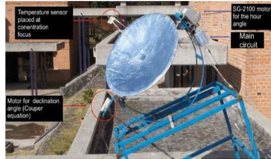
Figura 4. Sistema controlado por dsPIC.
