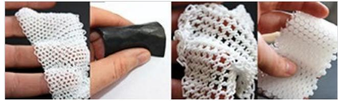
Figura 3. Ejemplo de textiles impresos en 3D. Reproducida de [20].
