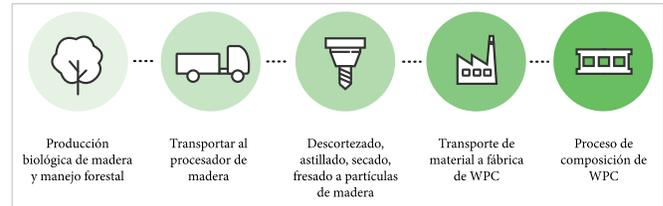
Figura 1. Ciclo de vida de la madera de la cuna a la fábrica (*cradle-to-gate*). Fuente: Elaboración propia, de acuerdo con las normas EN 15804 y EN 16485, adaptada de Sommerhuber *et al.* [16].
