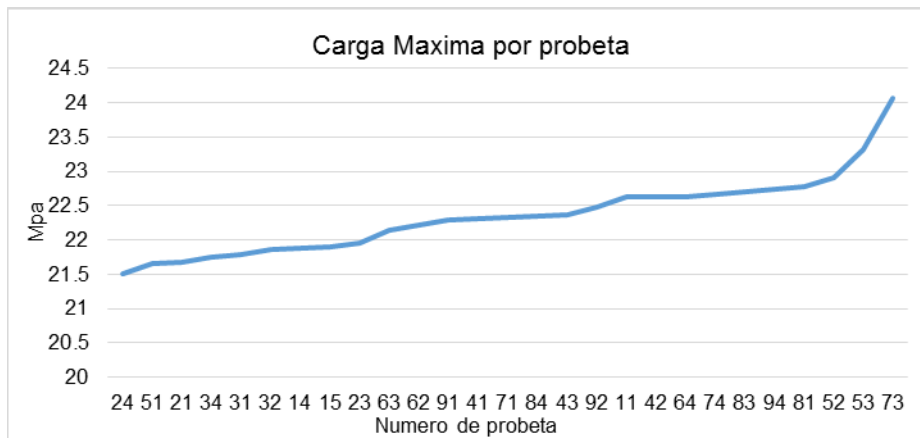
Figura 3.10. Capacidad de carga máxima acumulada por probeta. Fuente: Elaboración propia.
