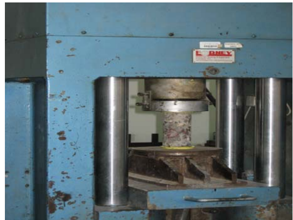
Figura 9 Prueba de compresión de un corazón, usando la máquina universal
