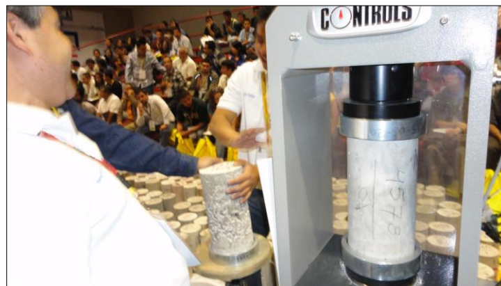
Fig. 2. Ensaye de los cilindros de concreto en el concurso.
