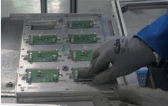
Fig. 1. Pallet de 8 unidades con PCB's y ensamble manual de conector a PBC's
