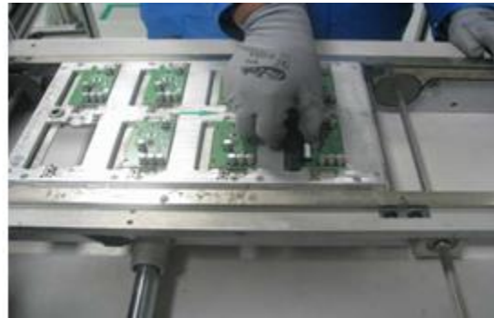
Fig. 1. Pallet de 8 unidades con PCB's y ensamble manual de conector a PBC's
