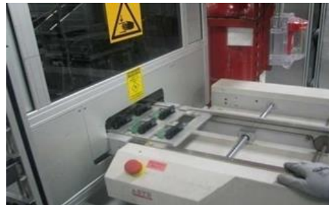
Fig. 1. Pallet de 8 unidades con PCB's y ensamble manual de conector a PBC's
