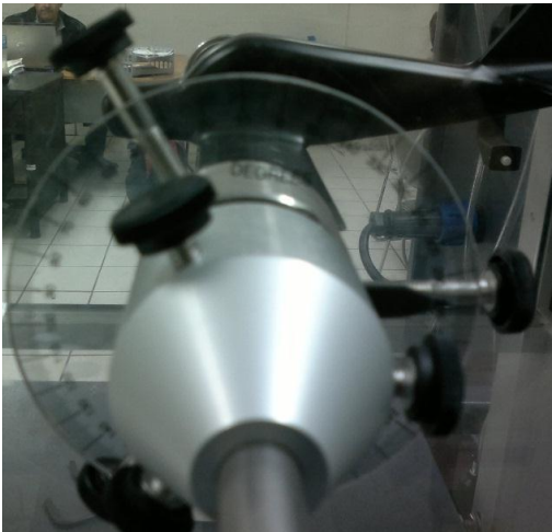
Figura 4 Ajuste de los ángulos de ataque de forma manual.
