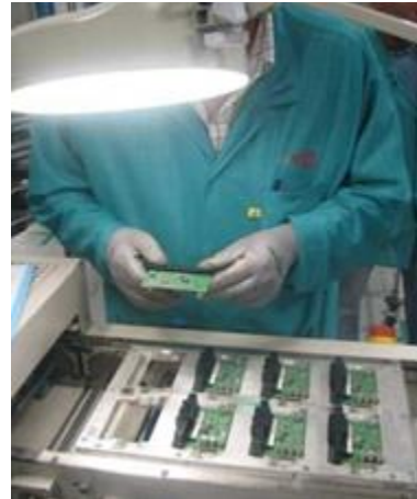
Fig. 6. Inspección visual del PCB por parte del operador
