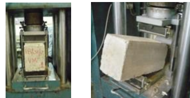
Fig. 6. Determinación de la resistencia a flexión de una viga de concreto simplemente reforzada.
