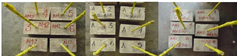
Fig. 3. Cubos para revisión de adherencia
