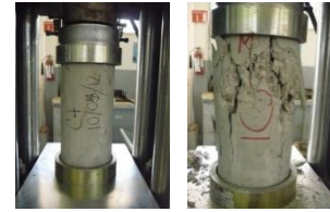
Fig. 2. Revisión de la resistencia a compresión de los cilindros de concreto
