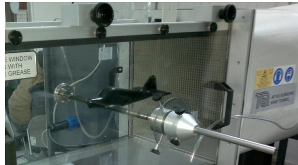
Fig. 3. Cámara de viento, control manual del ángulo de ataque.
