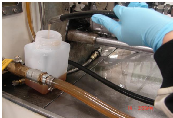
Fig. 6. Desconexión de una línea para toma de muestra
