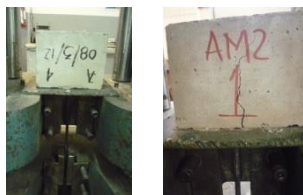
Fig. 4. Extracción de una varilla embebida en un cubo de concreto.
