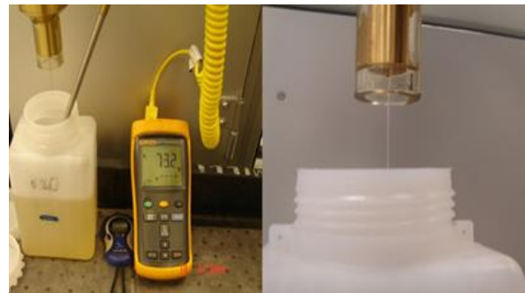
Fig. 11. Prueba de viscosidad mediante Copa Viscor 1487
