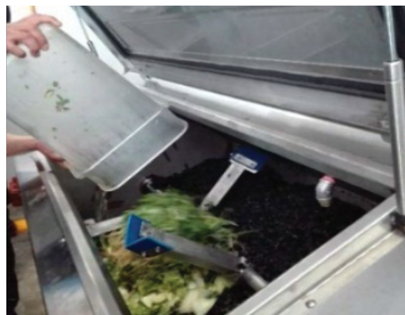
Figura 5. Ejemplo de la introducción de insumos al biodigestor aeróbico para la obtención de composta.
