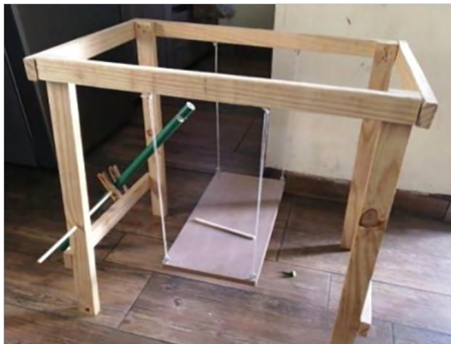
Figura 1. Prototipo de armonógrafo, placa detenida por cuatro cuerdas. A la izquierda se observa el dispositivo que sostiene perpendicularmente un tubo al que se le acopla un plumón. Con el permiso del autor .
