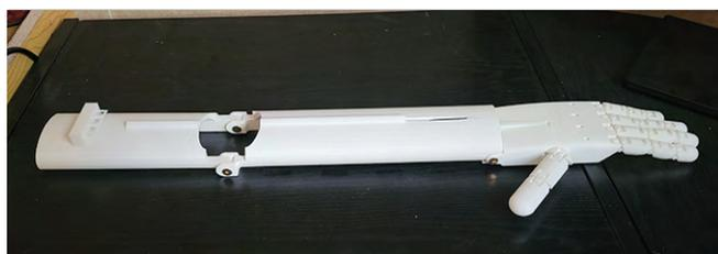
Figura 28. Ensamble completo de la prótesis EVA.
