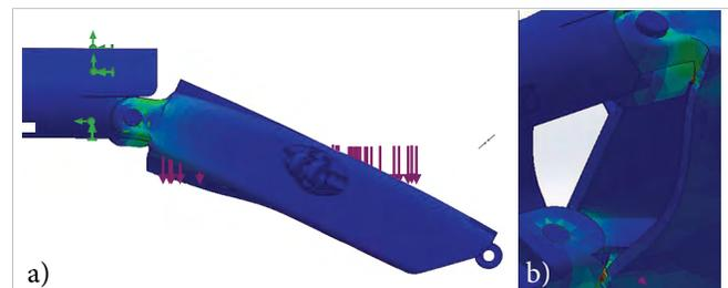
Figura 20. Deformación resultante en PLA en SolidWorks: a) simulación de la aplicación de las fuerzas en posición de pronación y b) acercamiento a la zona afectada en la parte inferior de la zona de ensamble mano-antebrazo.
