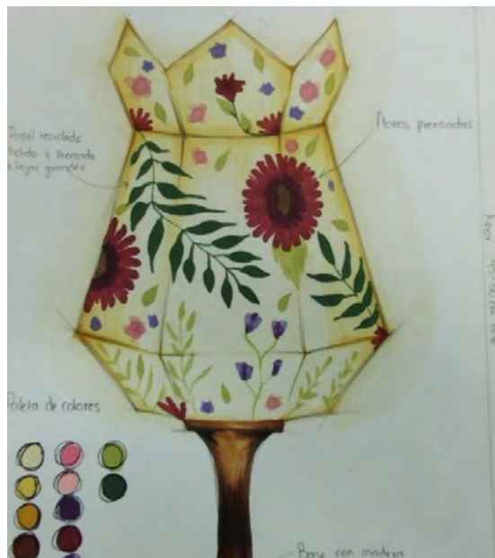
Figura 5. Boceto detallado de la luminaria. Se especifica el uso de papel reciclado obtenido mediante el molido y prensado de hojas reutilizables, la incorporación de flores prensadas en la pantalla, la selección de la paleta de colores y el uso de madera reciclada en la base, con una altura aproximada de 40 a 50 cm. Fuente: elaboración propia.
