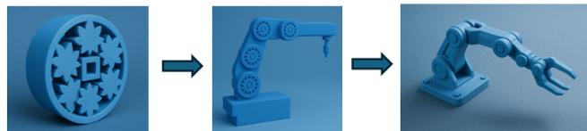
**Figura 3.** Rodamientos en manufactura aditiva como articulaciones robóticas sin ensambles para fabricar brazos robóticos.
