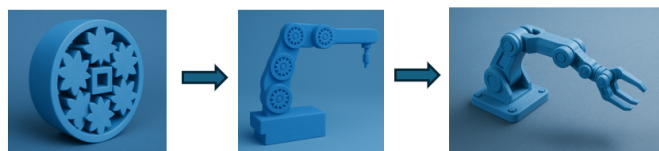
Figura 3. Rodamientos en manufactura aditiva como articulaciones robóticas sin ensambles para fabricar brazos robóticos.
